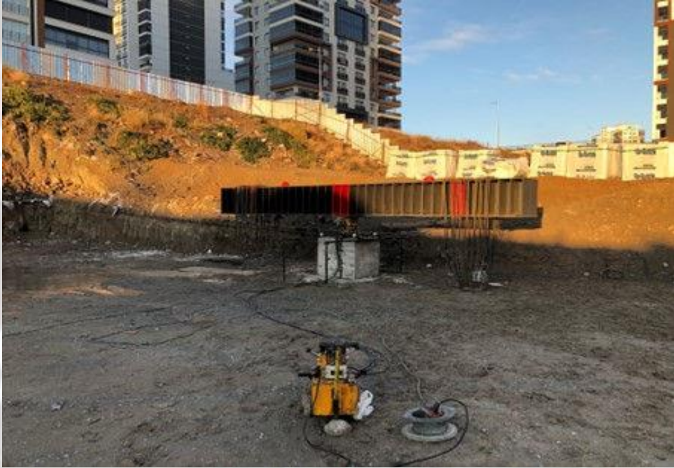
Şekil 21. 3800 kN Temelaltı Fore Kazık Yükle Testi (Ankara, 2022)
