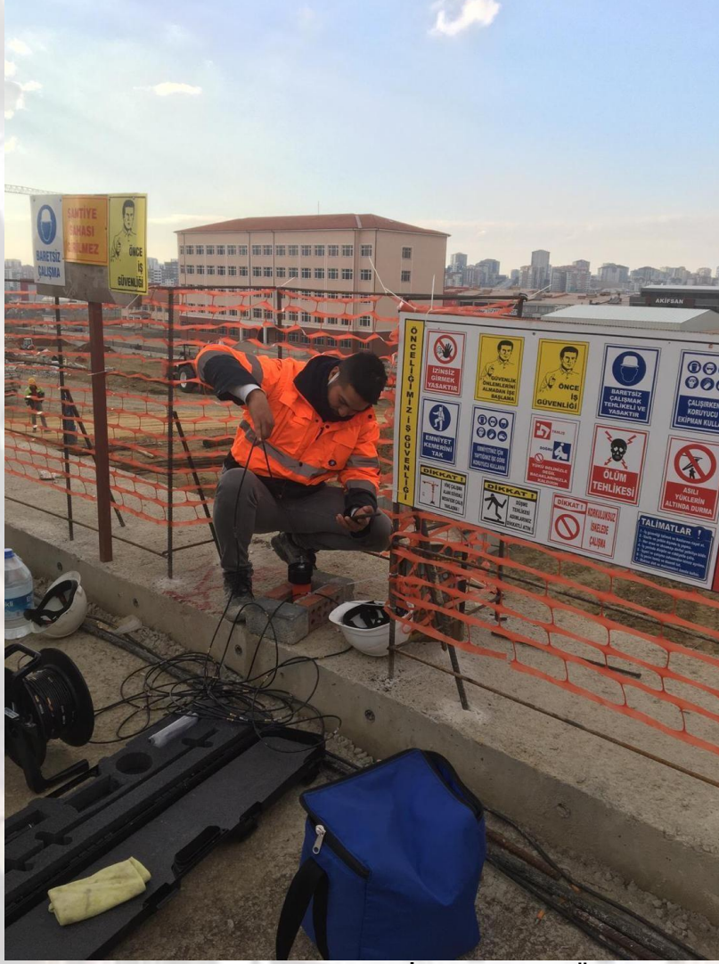
Şekil 24. OTOKENT 26 m İnklinometre Ölçümü
