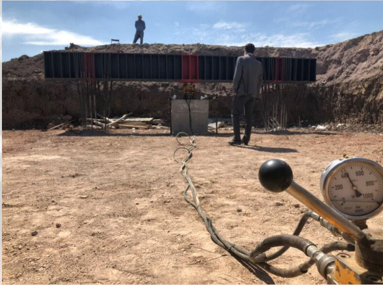
Şekil 23. 3300 kN Temelaltı Fore Kazık Yükle Testi (Ankara, 2022)
